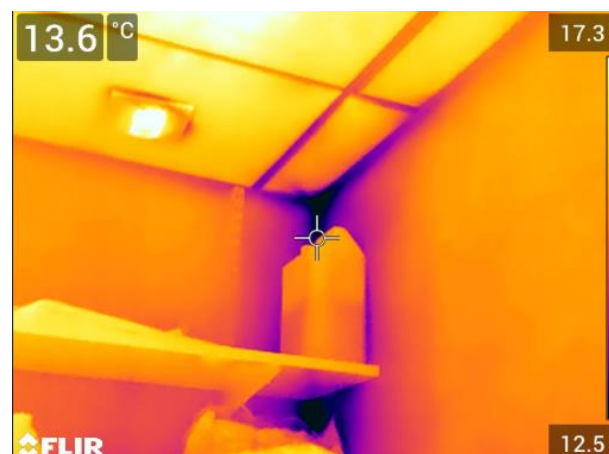
Fig 16 : Pont thermique liaison refend dans local ménage donnant sur local climatisation
